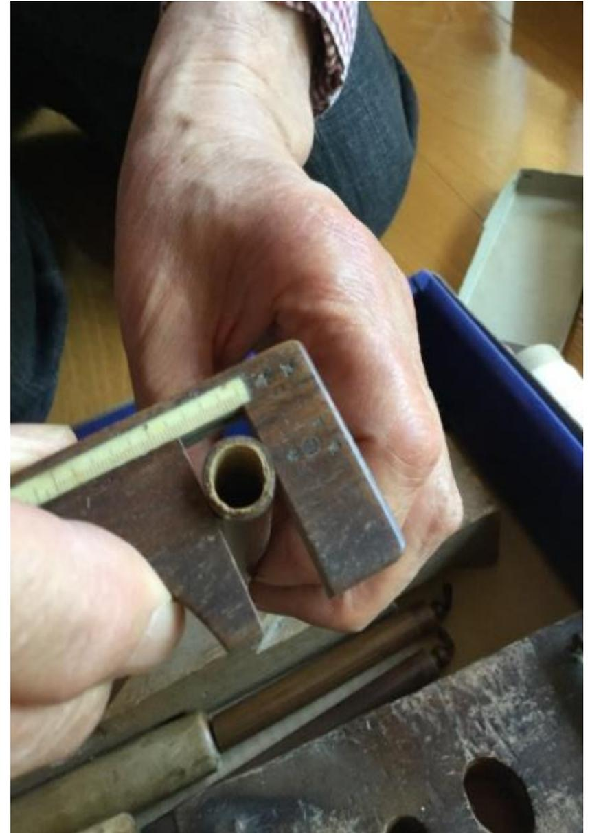
玉尺で軸の太さを測る
