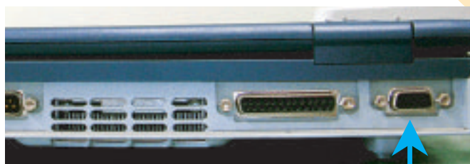
コンピュータ側の 信号ケーブル端子接続部
