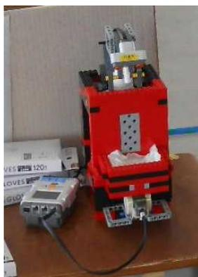
←ロボット研究部の 君が作成した「消毒液ディスペンサー」。ポンプ式のアルコール製剤容器をレゴブロックで作成
